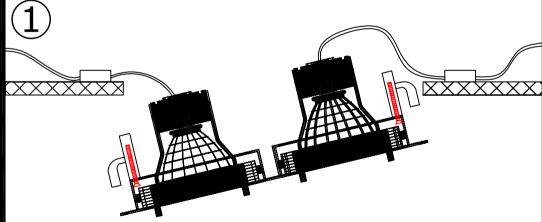
Elektrik bağlantılarını yapın. *Make the electrical connections*.
